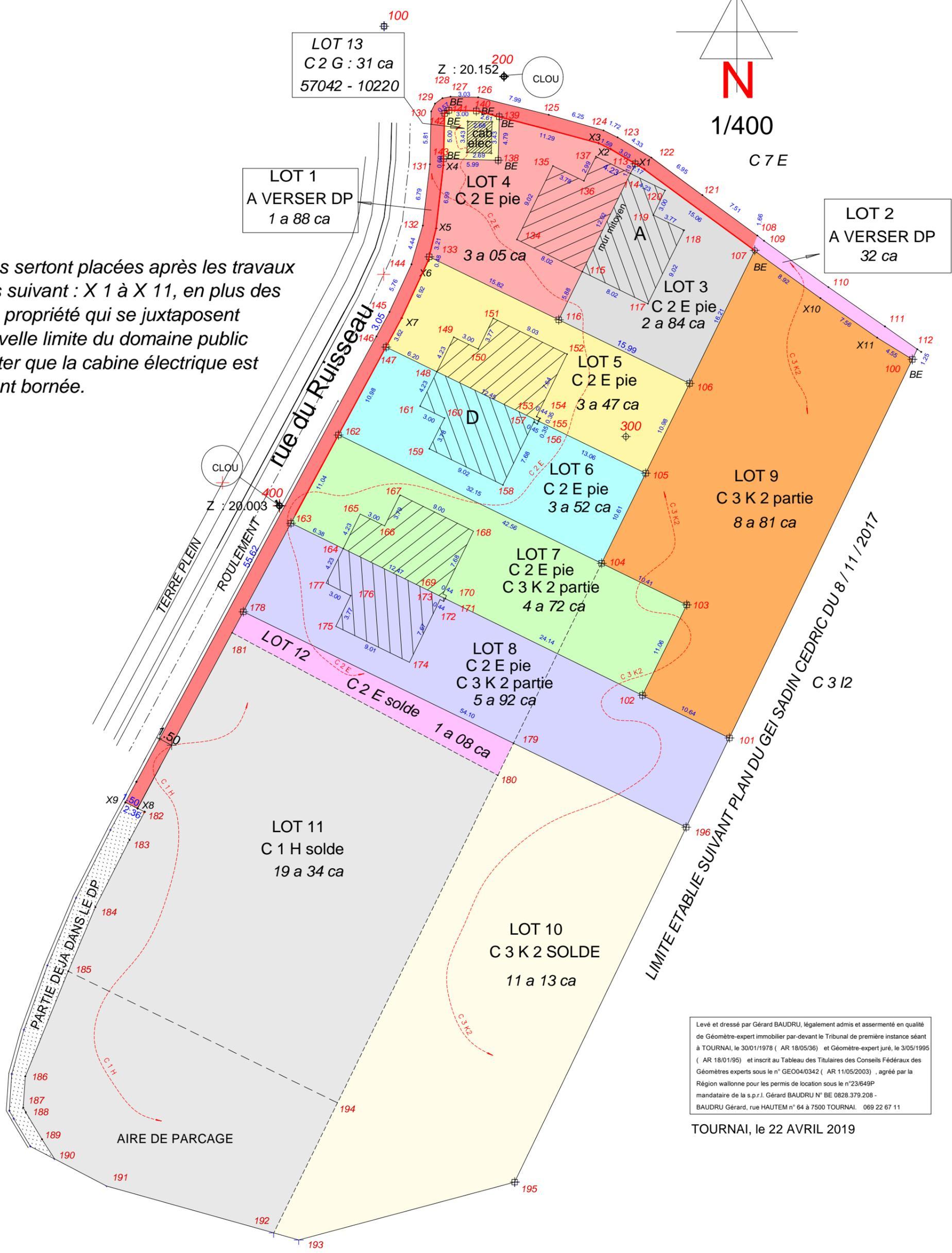
Les bornes seront placées après les travaux aux points suivant : X 1 à X 11, en plus des bornes de propriété qui se juxtaposent sur la nouvelle limite du domaine public Il est à noter que la cabine électrique est entièrement bornée.
